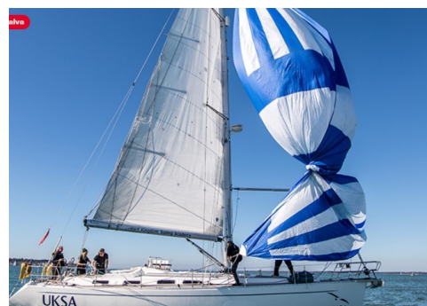
Spinnaker con "CARAMELLA" Errore grave del prodiere nell'issata
