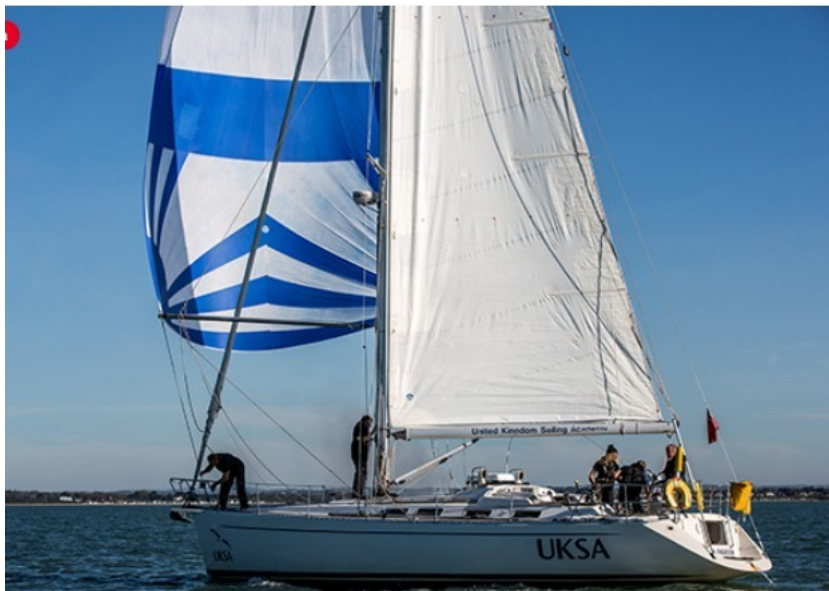
Spinnaker con "CARAMELLA" Errore grave del prodiere nell'issata
