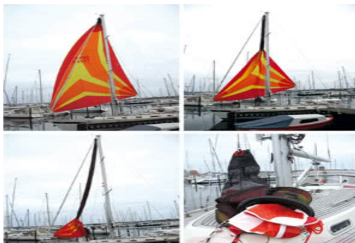
Calza per aprire o ammainare lo spinnaker e Anche gennaker
